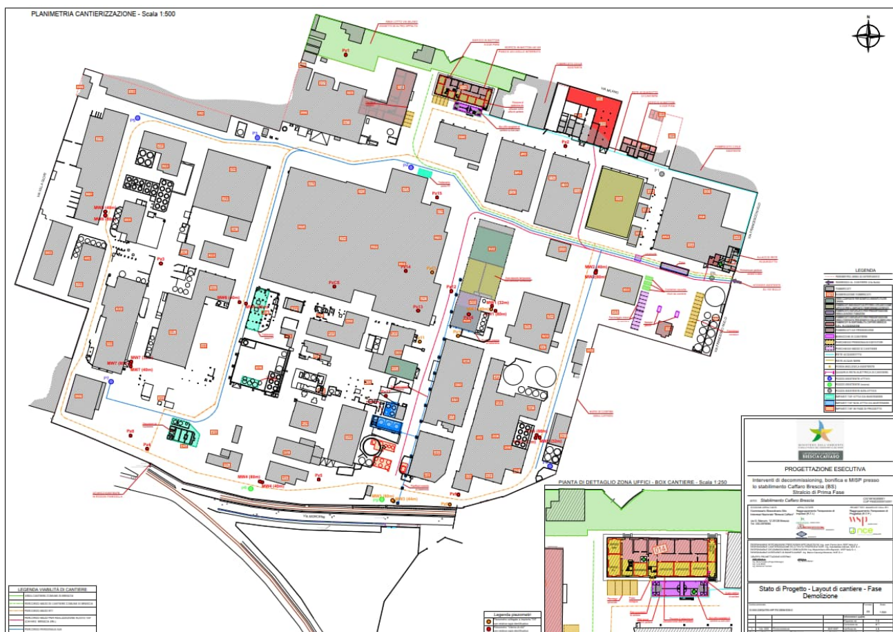
Figura 16: Layout di cantiere, fase di demolizione
